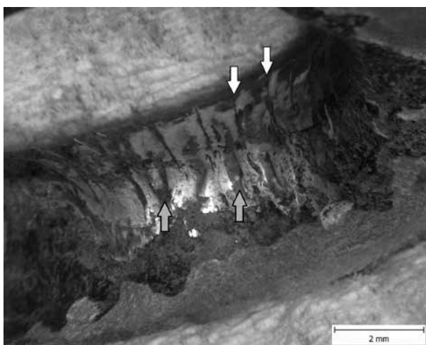
Obr. 3 Detail fragmentárně zachovaného plátování s viditelnými zástřihy (bílá šipka) i záseky (šedá šipka); (snímek z OM). – Fig. 3 Detail of partly preserved lapping with visible trims (white arrow) and cuts (grey arrow); (OM picture).
