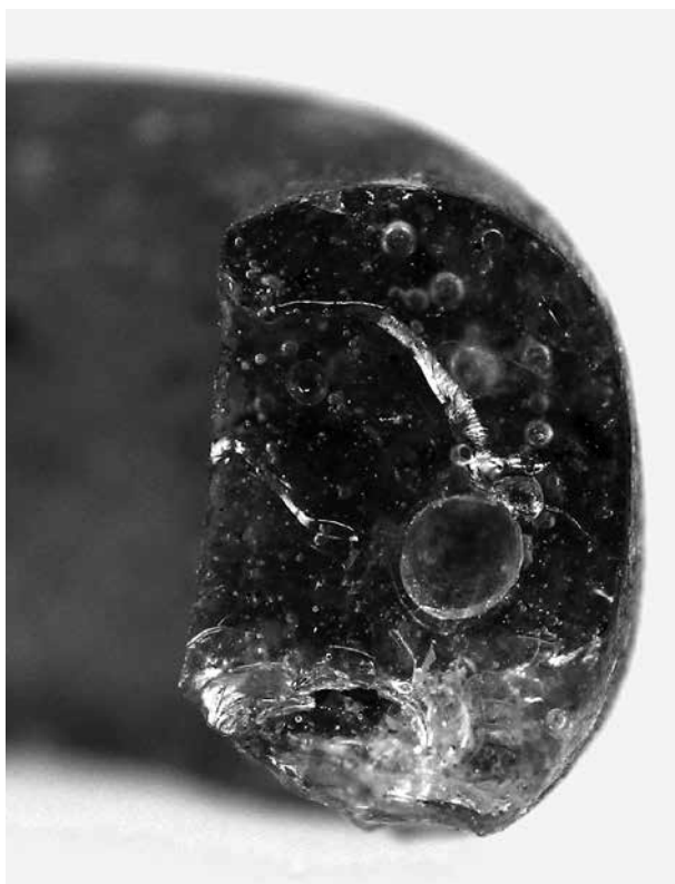
Obr. 8 Detail lomu s viditelnou bublinatou strukturou skla (snímek z optického mikroskopu). – Fig. 8 Detail of fracture with visible bubble-like structure of glass (OM picture).
